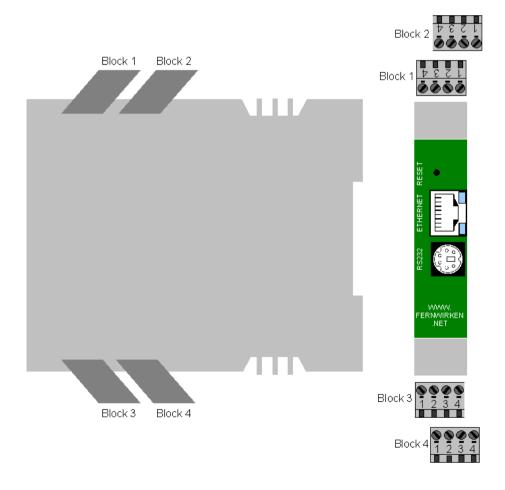
Lage und Belegung der vier Schraubklemmblöcke.
