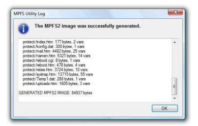
In diesem Fenster wird eine Zusammenfassung angezeigt. Am Ende ist der verwendete Speicherplatz angegeben (84937 bytes generated ca. 85Kb). Der max. Speicherplatz des NET-Systems beträgt 200KB.
